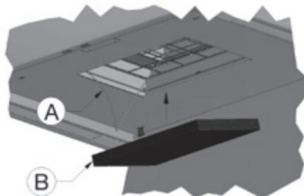
Der Feder (A) zusammen kneifen und nach unten drehen. Den monoblock Filter (B) installieren.
