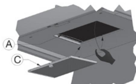
Der Feder (A) wieder zusammen kneifen und befestigen in der Schlitz. Den Fetfilter (C) installieren. Kleben Sie den Schließen Sie der Unterplatte wieder.
