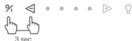
De functie kan ingeschakeld worden door de toets ① en toets ③ tegelijk in te drukken voor 3 seconden. De 2e en 3e LED knipperen keer ter bevestiging (Het toestel moet uitgeschakeld zijn).
