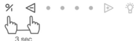
Die Funktion kann eingeschaltet werden, indem Sie die Tasten ① und ③ 3 Sekunden lang gleichzeitig gedrückt halten. Die zweite und dritte LED blinken 3 Mal zur Bestätigung. (Das Gerät muss ausgeschaltet sein.)
