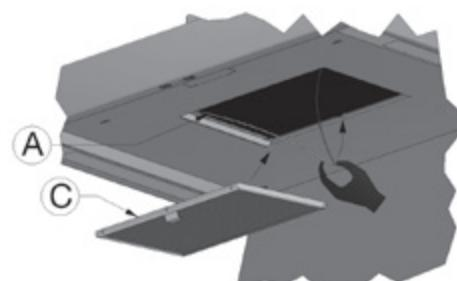
Sluit de sluitveer (A) door deze opnieuw samen te knijpen en vast te zetten in de voorziene sleuf. Plaats de vetfilter (C) terug in de dampkap. Sluit de onderplaat.
